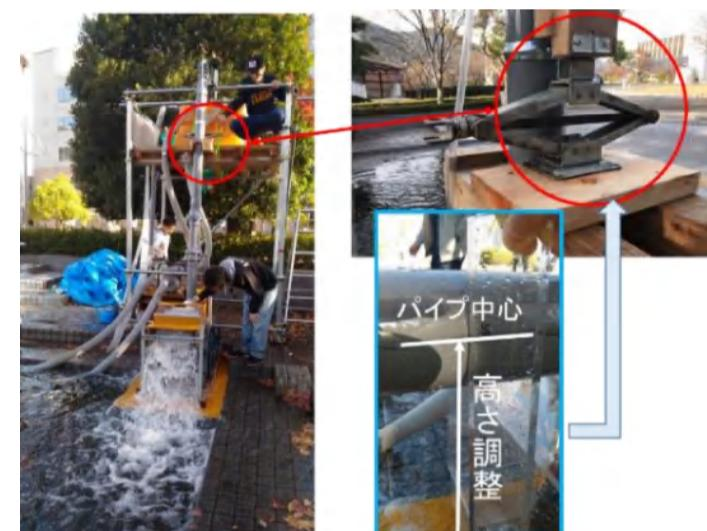
図-12 導水路の高さを調整した発電実験
